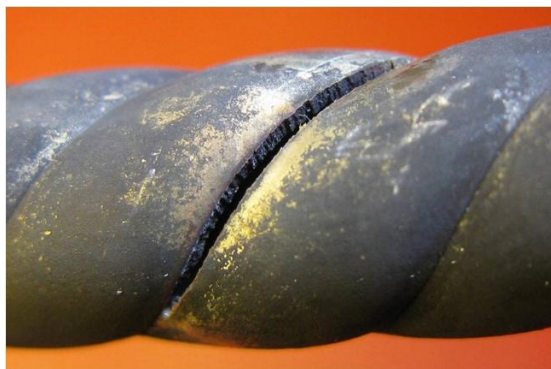
Obr. 16: Trhliny na dně vrubu vrubované trubky. Charakter trhliny je typický projev korozního praskání pod napětím (zřejmě vliv prostředí s obsahem chloridů a zbytkového napětí po tváření vrubů nebo tepelného napětí od střídání teplot)
