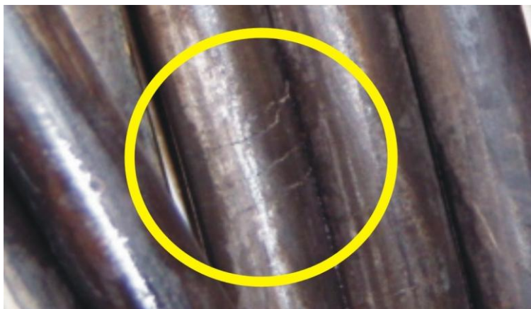
Obr.15: Korozní únavové trhliny na trubce 8x0,6 mm výměníku. Případ výskytu korozních trhlín na nechlazené trubce v důsledku nepřiměřené teplotní zátěže v prostředí termooleje s deklarovaným minimálním obsahem chloridů do 10ppm. Viz. obr.13. Nejsou zde vidět žádné chloridové důlky ani korozní zbytky. Na jiném místě teplosměnné plochy se vyskytovaly již otevřené trhliny v materiálu jako projev korozního praskání pod napětím. Však bez projevů pittingu.
