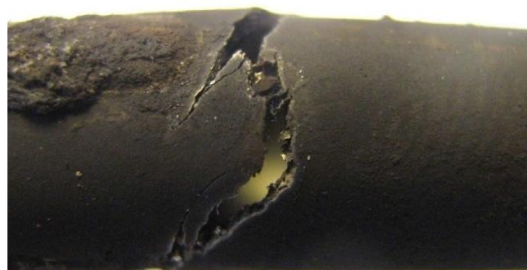
Obr. 11: Transkrystalické korozní trhliny na trubce výměníku. (metalografický lept, zvětšeno 200x a 500x). Korozní trhliny se mohou šířit podél zrn – mezikrystalická koroze, nebo i napříč zrny – transkrystalická koroze Trubka 8x0,6mm. ( Laboratorní zpráva)
