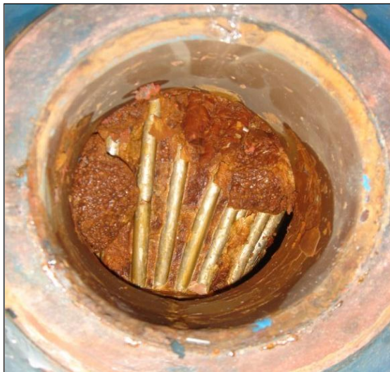
Obr.22: Pevné úsady na vstupu do šroubovicového výměníku (oblast Hané). Pozn. Pórovitost úsad ovlivňuje jejich tepelnou vodivost. Uhlíčan vápenatý krystalizuje ve třech formách – Kalcit, Aragonit, Vaterit (v přírodě vzácně) Každé krystalová forma má také jinou teplotní závislost jeho rozpustnosti ve vodě.
