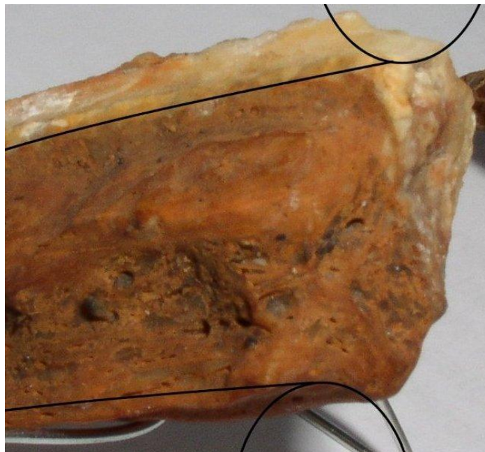
Obr.23: Část vylomené vápenaté úsady, která zcela vyplňuje prostor mezi trubkami v trubkovém výměníku a úplně znemožňuje průtok na trubkovém svazku. (Oblast Ústí nad Labem) Zvětšeno.
